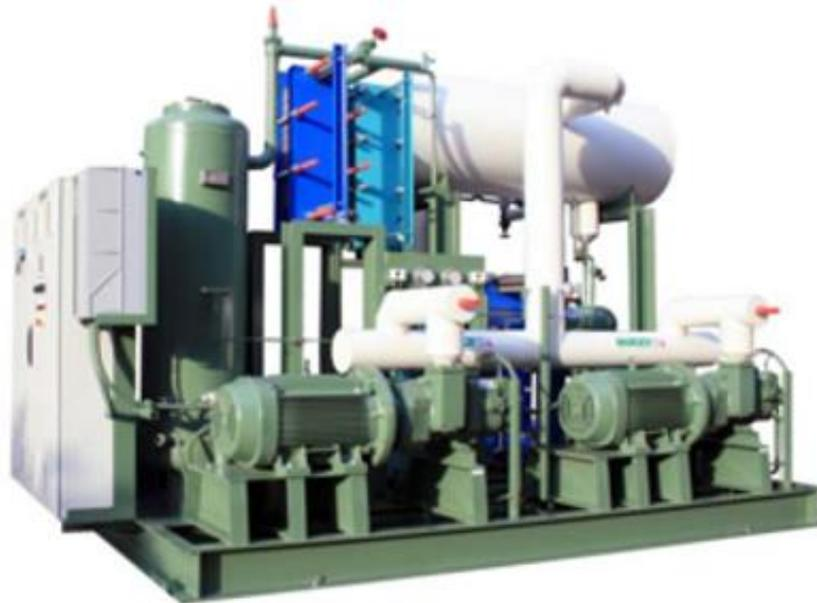
O compressor é geralmente constituído por uma bomba dotada de um tubo de aspiração e compressão, possuindo um dispositivo que impede fugas de gás e entrada de ar atmosférico. Situado entre o evaporador e o condensador, aspira a amônia evaporada e a encaminha ao condensador sob a forma de um vapor quente sob pressão elevada.
